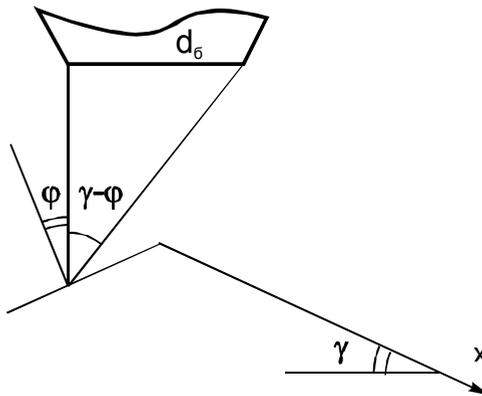
Рис. 3. До визначення найменшої висоти розташування бункеру
