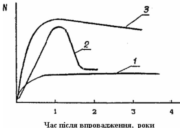
**Рис.1.** Залежність відмов від рівня управління якістю: N – число відмов на рік; 1 – крива відмов в умовах управління якістю; 2 – крива відмов в умовах системи контролю якості; 3 – крива відмов в умовах відсутності системи управління якістю.
